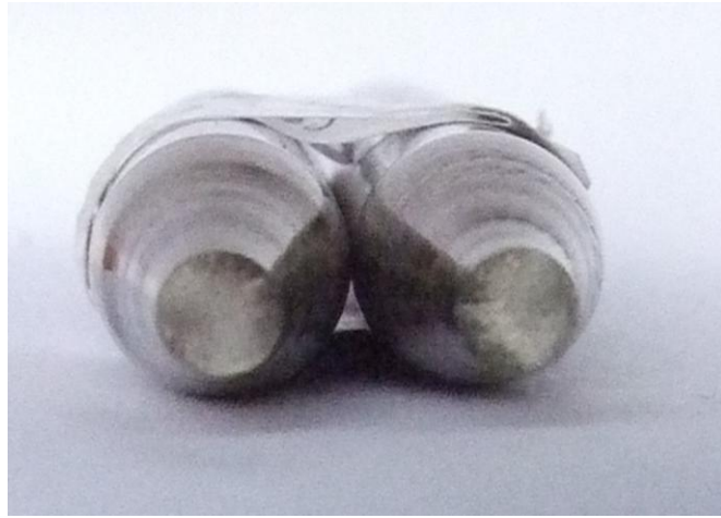
Gambar 4.7. Pola patahan spesimen dengan beban 4 Kg
