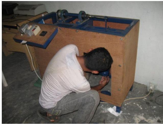
Gambar 4.4. Pemasangan beban pada spesimen
