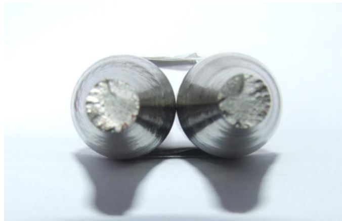
Gambar 4.7. Pola patahan spesimen dengan beban 8 Kg
