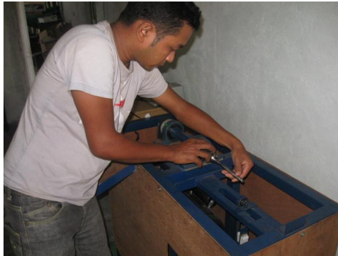
Gambar 4.2. Pemasangan Spesimen pada Collet
