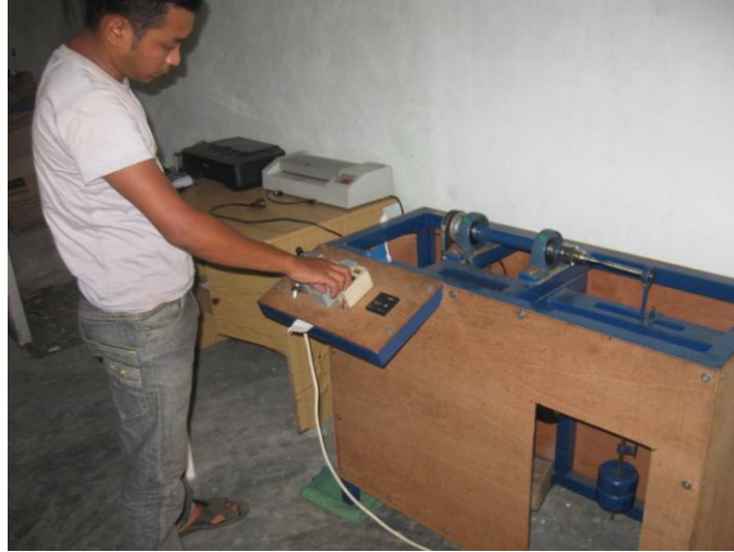
Gambar 4.5. Proses menghidupkan alat uji lelah
