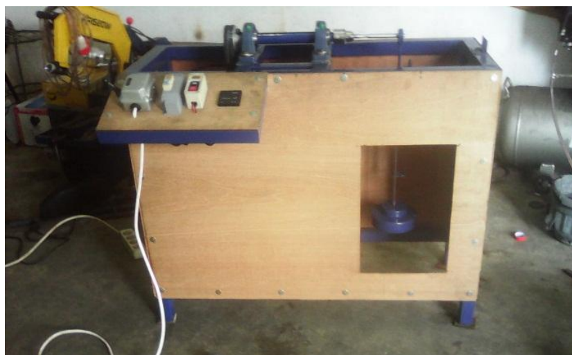
Gambar 3.2. Mesin uji lelah tipe cantilever rotating bending
