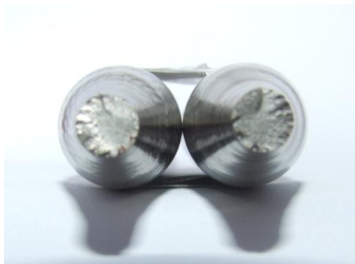
Gambar : 4.4. Pola patahan spesimen dengan alat uji tipe CRB, dengan beban 8kg pada tegangan maksimum 198,10 Mpa.
